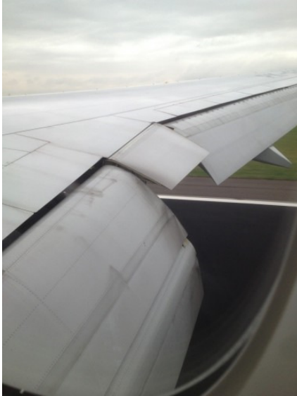
Figuur 10: Kleppen van een verkeersvliegtuig
